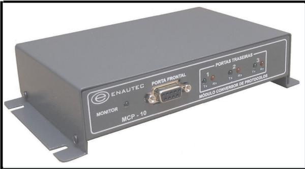
O MCP-10 é um equipamento que viabiliza a comunicação entre diversos dispositivos, por meio da conversão de protocolos. Além de trazer os protocolos padrão Modbus RTU e DNP 3.0, o MCP-10 permite a adição de protocolos proprietários de maneira fácil, devido à sua constituição baseada em um hardware microprocessado de alto desempenho e um firmware modular.
