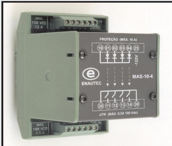
O MAS-10 interliga contatos sob 125 VCC, como relés de proteção, a entradas de baixa tensão de equipamentos eletrônicos, como UTRs. Isto possibilita a adaptação de Subestações de Energia Elétrica, que utilizam relés eletromecânicos, para receberem equipamentos de supervisão integrada, visando a automação de SEs.
