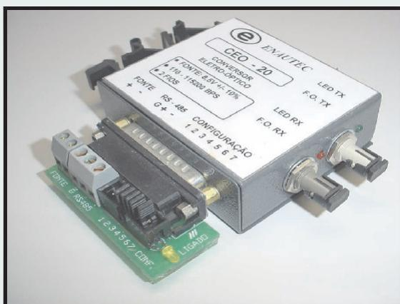
O CEO-20 é um dispositivo de comunicação que realiza a conversão entre a interface RS-485 e a interface de fibra-ótica e vice-versa. Estes dois tipos de mídia de comunicação de dados são amplamente utilizados em ambientes industriais devido à elevada imunidade a ruídos e simplicidade de uso.
