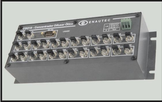
O CDO-10 é um equipamento que permite a distribuição e concentração de dados entre um canal principal de comunicação e 12 canais secundários, os quais utilizam fibra óptica. O canal principal permite utilizar tanto fibra óptica quanto sinais RS-232. O uso da fibra-óptica confere uma elevada imunidade às interferências eletromagnéticas e, portanto, a conversão de sinais elétricos para ópticos torna os equipamentos menos sensíveis aos ruídos eletromagnéticos.
